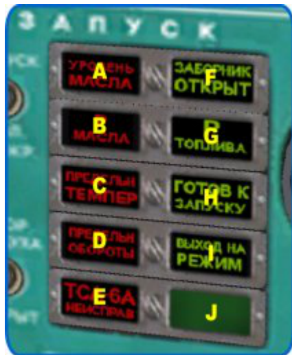
Рис. 10. Панель сигнализации ВСУ.
