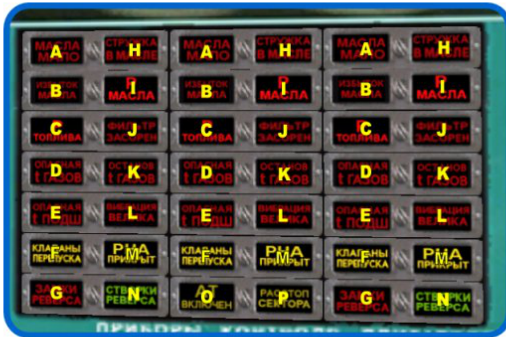
Рис. 11. Панель сигнализации двигателей.
