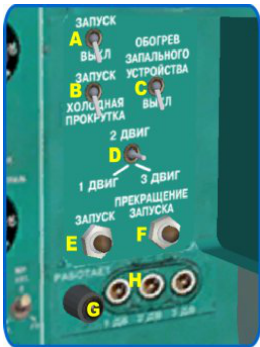
Рис. 12. Панель запуска двигателей.
